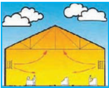
تصویر ۱-۲- مقایسه‌ی سیستم‌های گرمایشی جابه‌جایی و تابشی
